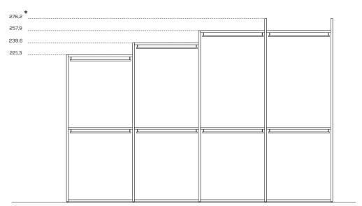
$<sup>^{\</sup>star}$  Spalle H 276,2 cm dotate di livellatori per fissaggio a soffitto \ 276,2cm-high side panels come with levellers for fastening to the ceiling.
